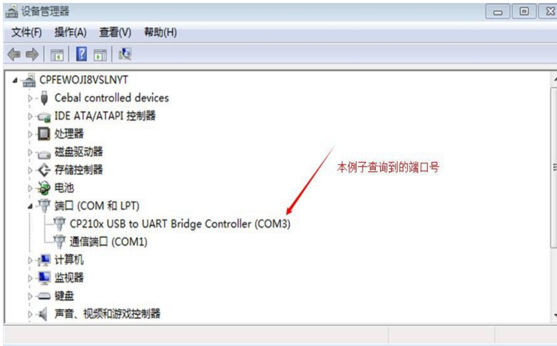
**步骤 4:** 打开附件中的串口调试助手 sscom32，设置波特率为 9600（注意：F\_9088 透传默认波特率为 9600，），在串口号选项下选择刚才你查到的端口号，并点击 打开串口 按键，至此环境搭建完成，串口调试助手环境设置如下图所示。
