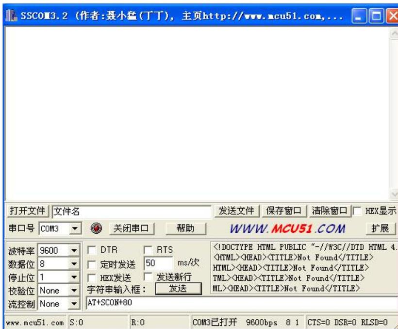
**步骤 2:** 点击完“发送”按键后，如果串口调试助手显示 OK，再复位 9088 模块。
